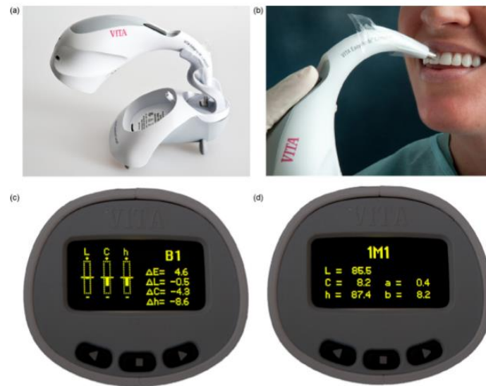
Figura 5. Aplicación clínica del espectrofotómetro EasyShade Compact. (a) Calibración del instrumento. (b) Medición del color. (c) Valores métricos de diferencia de color en comparación con el correspondiente tono del muestrario Vitapan Classical. (d) Valores de coordenadas de color y su equivalencia en el muestrario Vitapan 3D-Master (Chu y cols. 2010)
