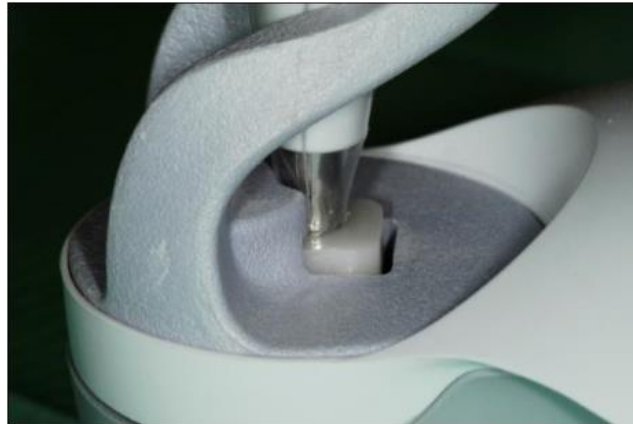
Figura 6. Calibración del espectrofotómetro Vita Easyshade Compact®
