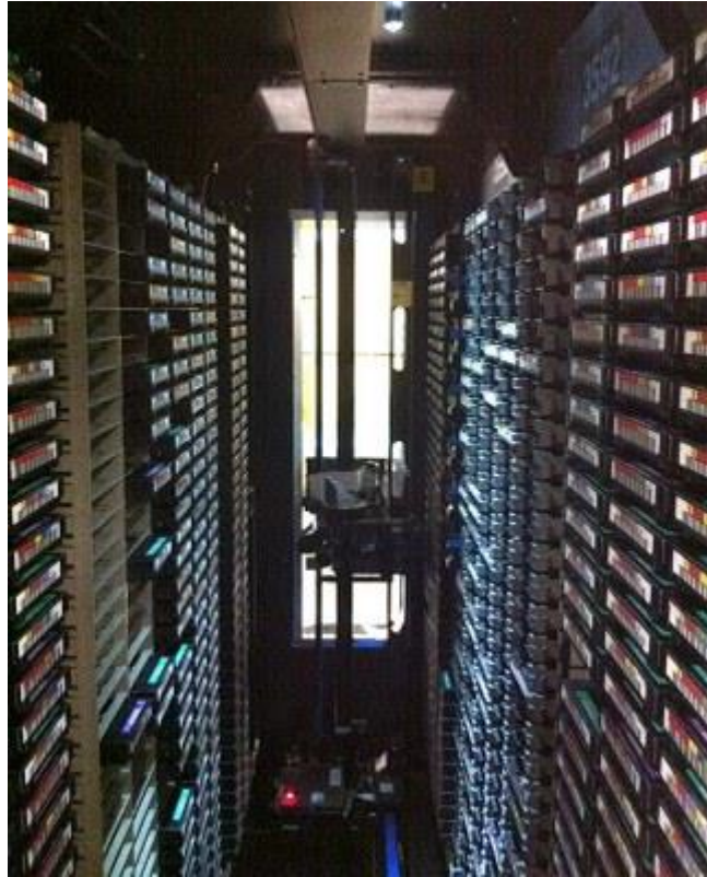
Fig. 11 Vista interior del robot TS3500
