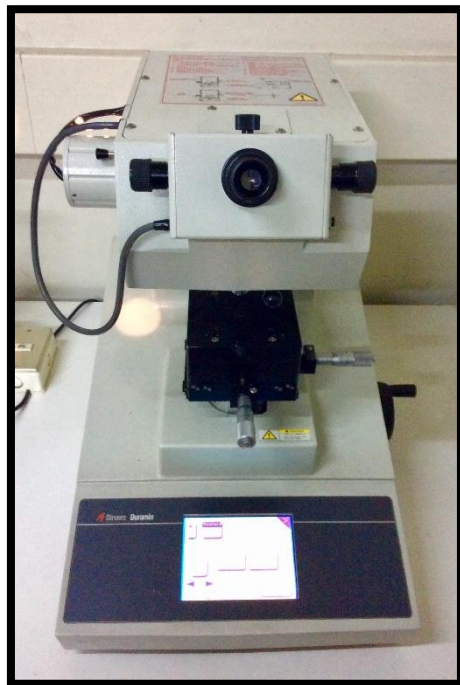
Figura 3. Imagen del microindentador de Vickers Struers Duramin (USA). Instrumento utilizado para la medición de dureza superficial de las muestras de esmalte.
