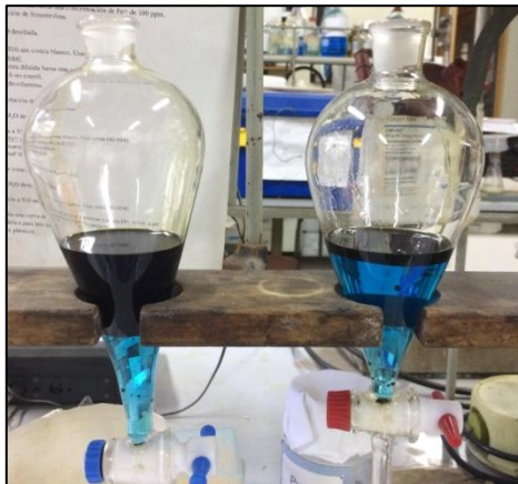
Ilustración 12. Experiencia de laboratorio: Embudos de decantación en soporte universal mientras se espera que las fases se separen.
