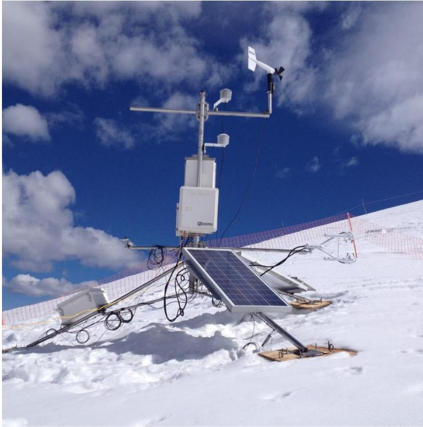
Figura 3.2: Instalación experimental del anemómetro sónico y de la estación meteorológica. Agosto de 2016. Fuente: Elaboración Propia.
