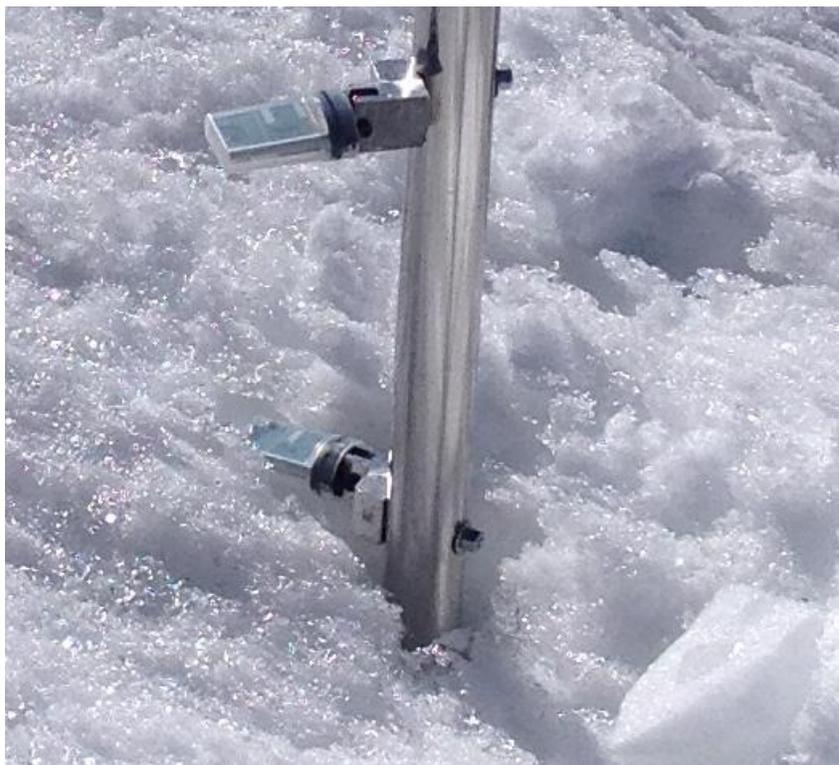
Figura 3.4: Acercamiento del contacto entre la nieve y el soporte de los sensores de luz en profundidad. Fuente: Elaboración propia.
