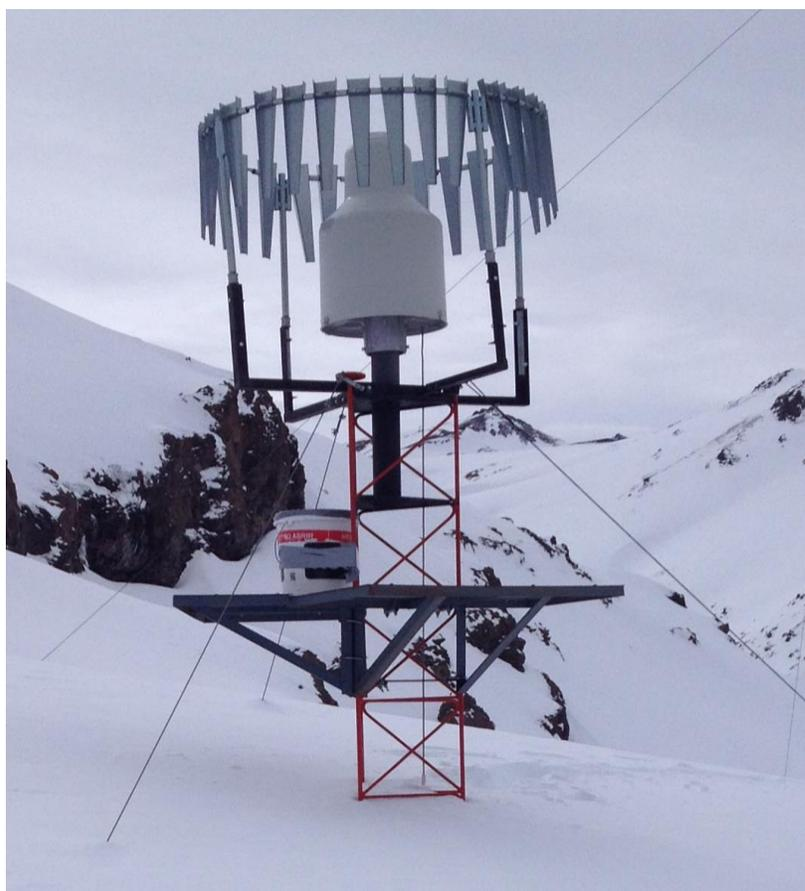
Figura 3.6: Pluviómetro instalado en estación Valle Nevado.
