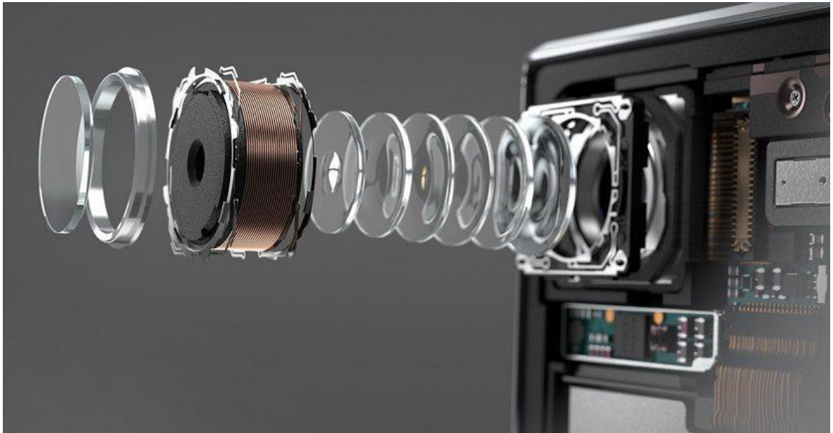
Ilustración 4; descomposición digital de una cámara de Smartphone Sony Xperia XZ Premium. Obtenida de www.sony.cl
