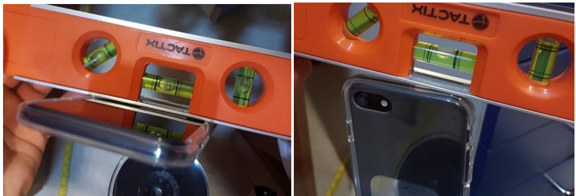
Ilustración 9. a y b: Ubicación perpendicular del Smartphone mediante nivel manual en distintos sentidos del espacio
