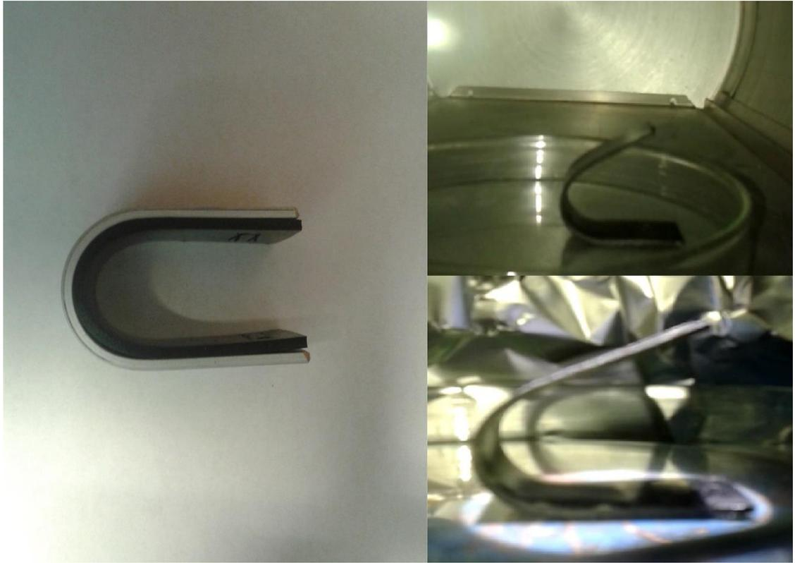
*Figura 23: Izquierda, disposición de la muestra en molde para preparar la forma temporal. Derecha, disposición de una muestra en el horno y bajo el Simulador Solar encendido.*
