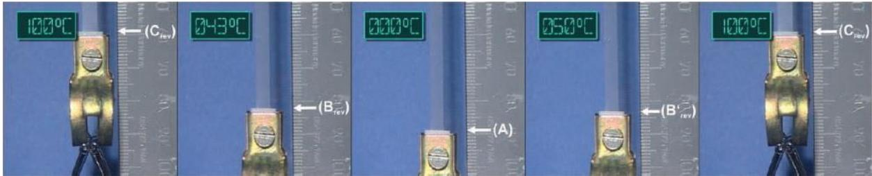
Figura 11: Efecto de triple memoria de forma de dos caminos, reversible, bajo tensión constante durante test termo mecánico. Primero, forma original C, B y A durante enfriamiento y posterior calentamiento B y C. [25]
