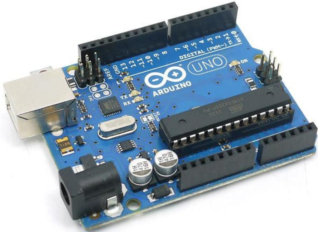
Figura 24: Microprocesador Arduino UNO.
