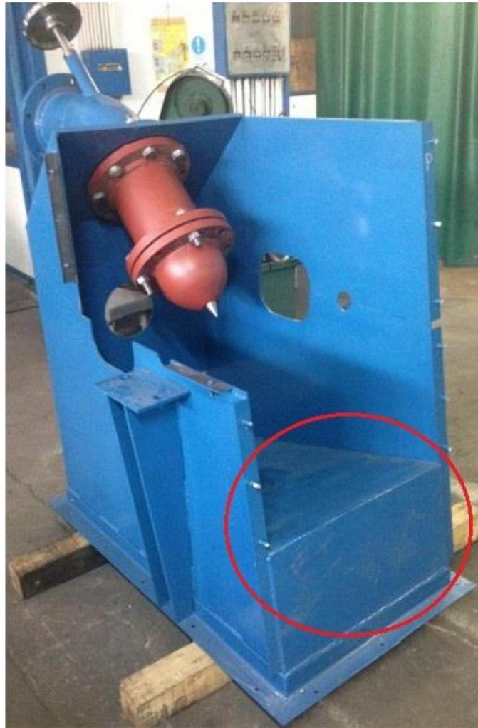
**Figura 3.3 - Parte inferior del housing e Inyector instalado del prototipo de laboratorio (rampla de salida de agua encerrada en círculo) [2]**
