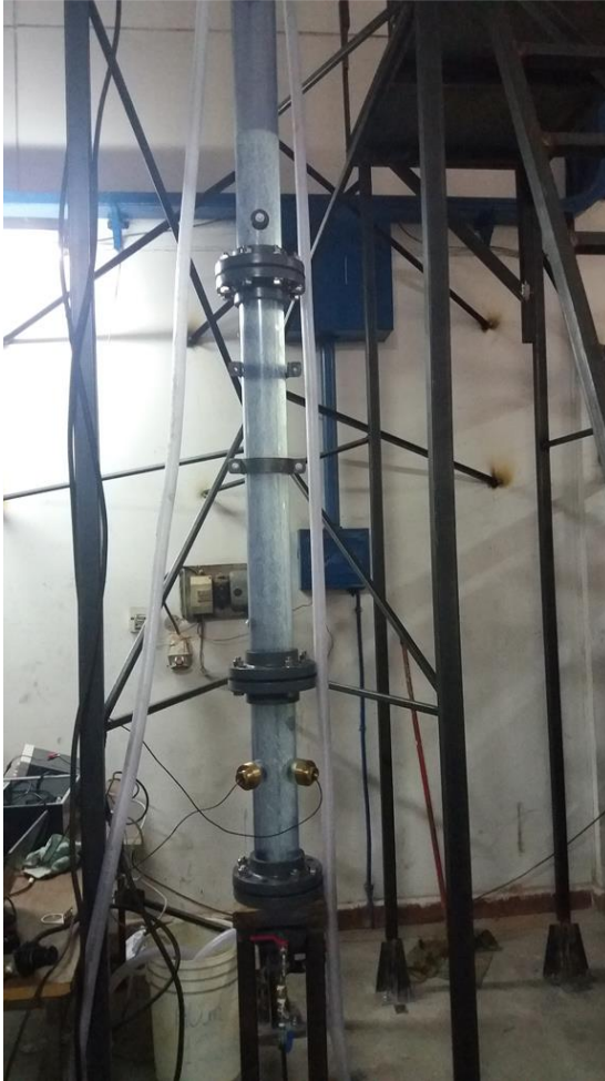
Figura 30: Columna 3-D (parte inferior). Posee llave de descarga en su base.
