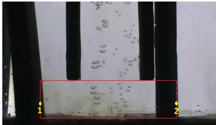
Figura 24: Puntos de muestreo N°1 y N°2 en volumen de control (con inyección de aire y barrera móvil instalada).
