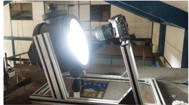
Figura 90: Equipo Bubble Viewer® con cámara fotográfica montado en la parte superior de la columna.
