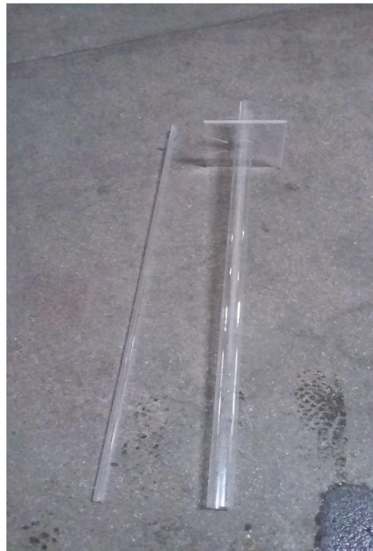
Figura 85: Tubos de acrílico y soporte utilizado para sostenerlos en la parte superior de la columna.
