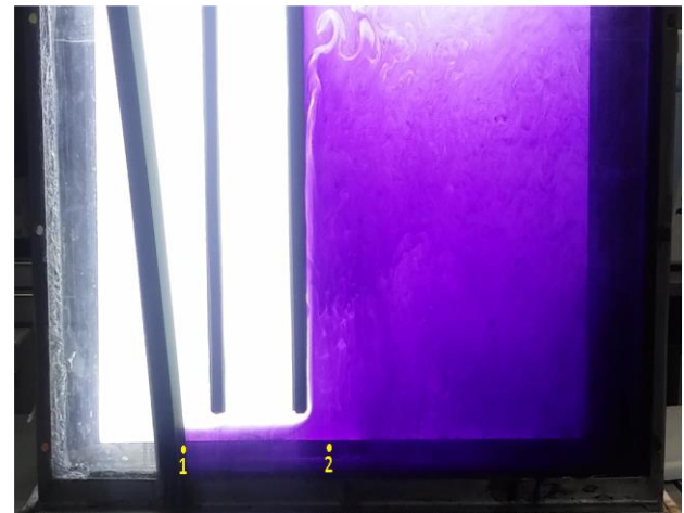
Figura 26: Fotografía del sistema sin flujo de aire en equilibrio para colorante.
