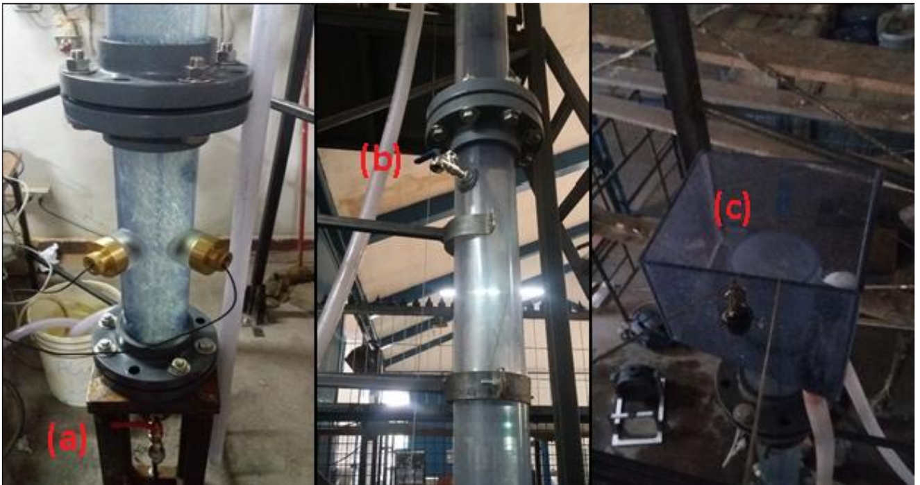
Figura 34: Puntos de toma de muestras a lo largo de la columna (a) Llave de evacuación basal (b) Llave de evacuación en cota media (c) Parte superior.
