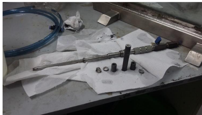
Figura 75: Lanza de columna 2-D con sus componentes.
