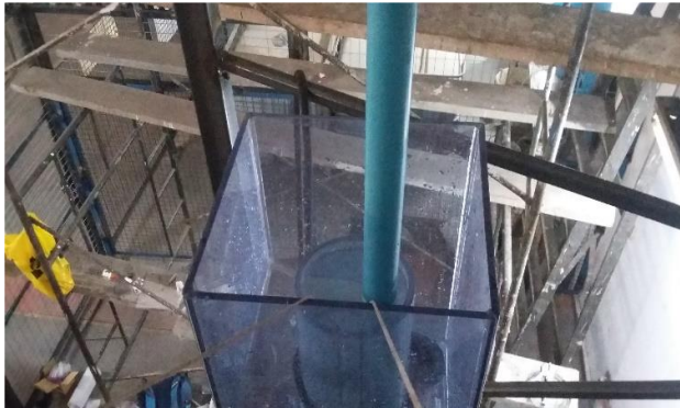
Figura 92: Tubo de muestreo de Bubble Viewer® conectado con columna.
