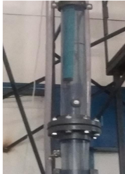
Figura 93: Extremo inferior de tubo de muestreo de Bubble Viewer® sellado con tapón.
