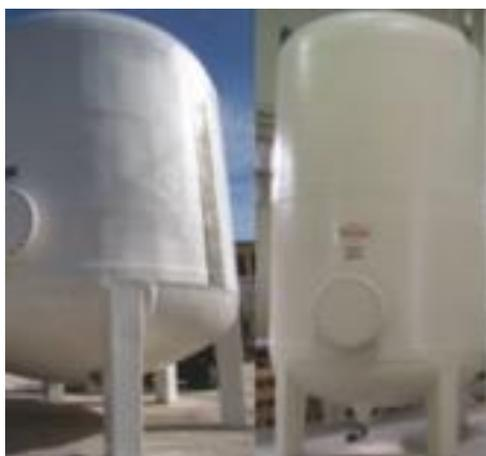
Figura 4.15. Estanque PRFV tipo D.
