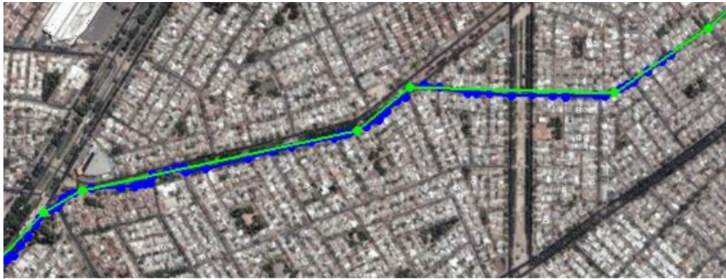
Figura 2.4: Ejemplo de resultados de simplificación de ruta, con verde la ruta simplificada sobre la ruta azul original. Fuente: [4]
