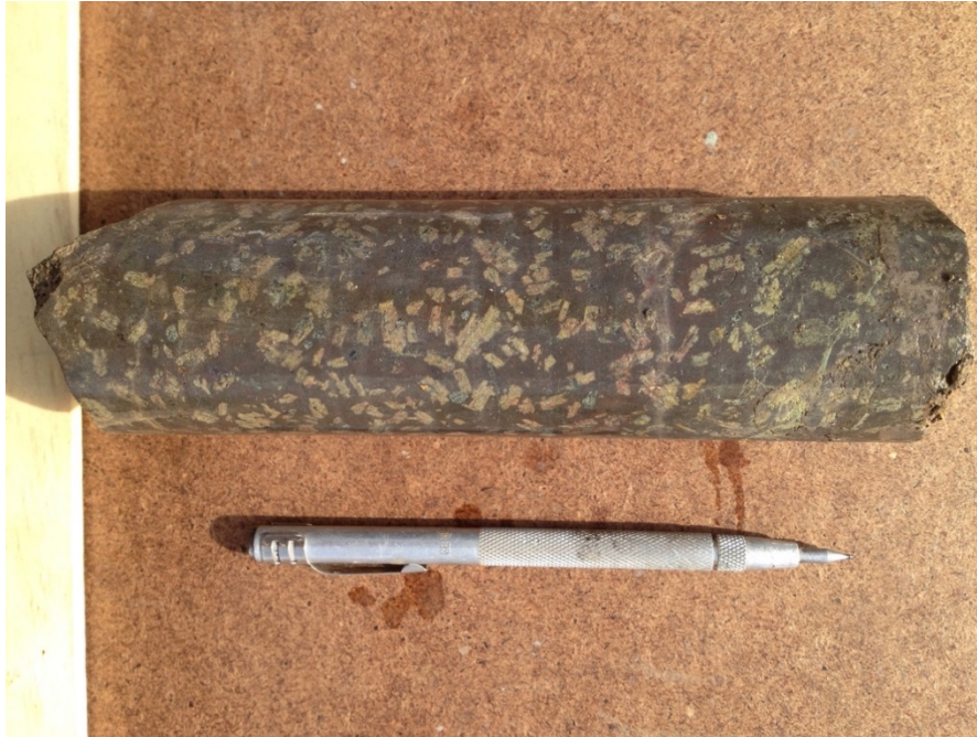
Figura 3.33. Andesita porfírica de grano grueso entre los 15,40 y 15,70 metros de profundidad. El tamaño de los fenocristales varía entre 5 mm y 1,5 cms y éstos se encuentran parcial a totalmente albitizados o epidotizados e insertos en una matriz débilmente cloritizada.
