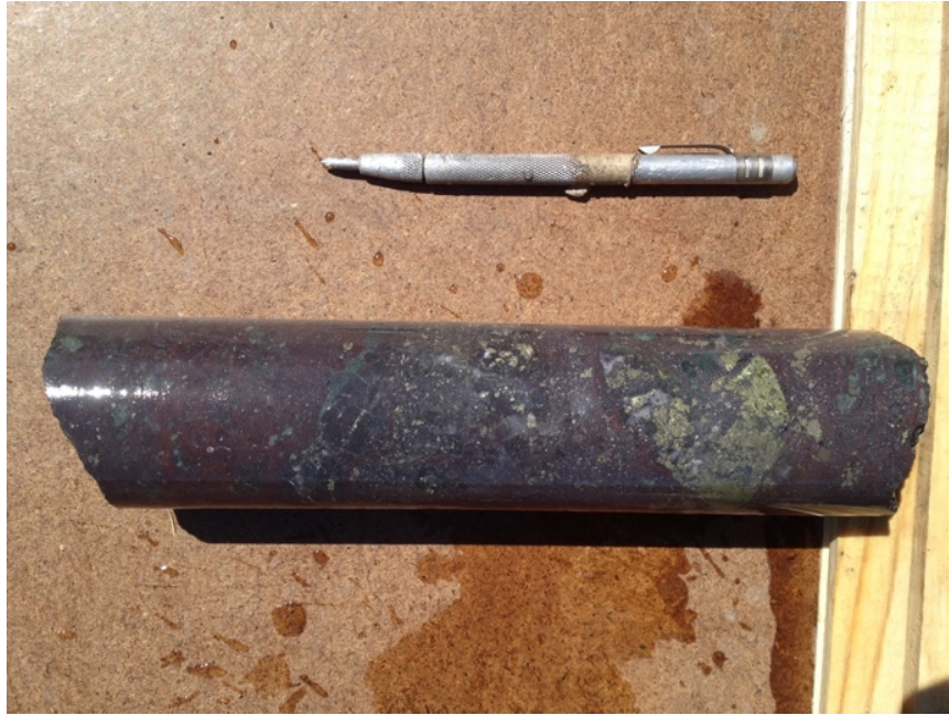
Figura 3.34. Tramo de posible intercepto de sondaje EN-396-16 con Veta Interior entre los 235,70 y 234,05 metros de profundidad. La veta de cuarzo presenta abundante hematita, calcopirita y pirita. En esta estructura, la hematita pulverulenta llega a contenidos de 60 % en volumen de roca, mientras que la calcopirita y pirita presentan contenidos de 15 % y 10 % respectivamente.
