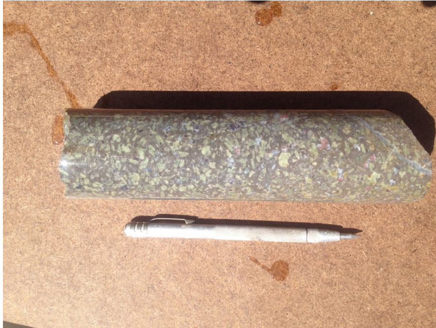
Figura 3.25. Andesita porfírica entre los 15,30 y 15,60 metros de profundidad con alteración clorita-epidota-albita-carbonatos. En la figura se aprecia la epidotización selectiva que presentan los fenocristales de plagioclasa.
