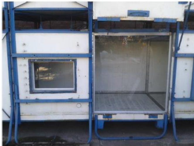
Figura 4.1 Vista frontal de paneles de acrílico en túnel de viento [2]
