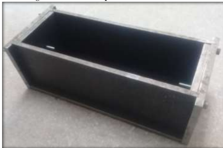
Figura III-3: Vista lateral del molde de la viga de hormigón.
