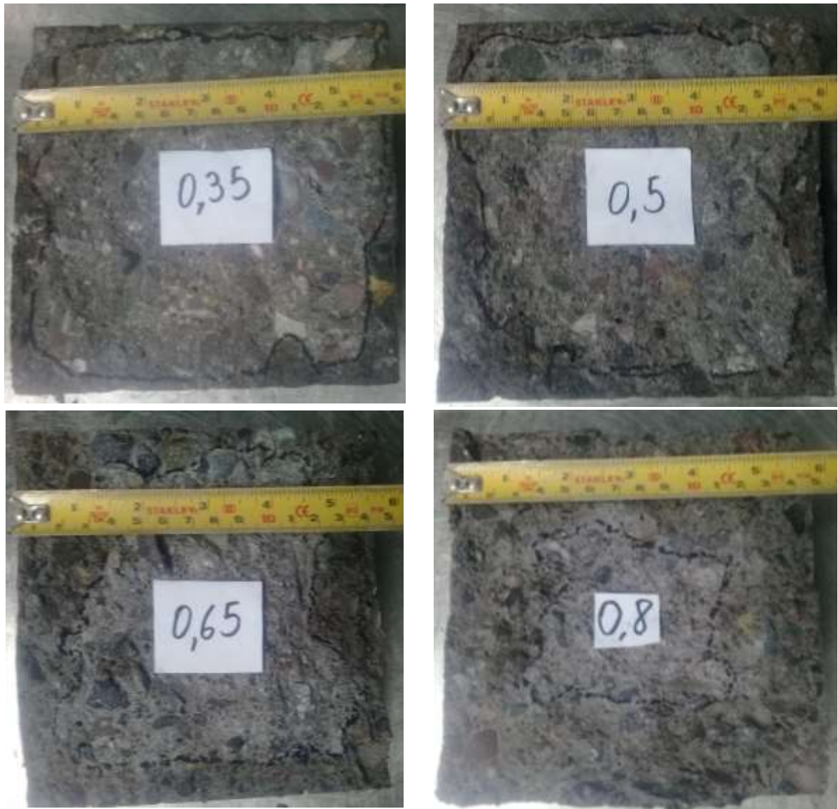
Figura IV-12: Fotografías de la penetración del agua de curado en las probetas cúbicas de 15 cm.
