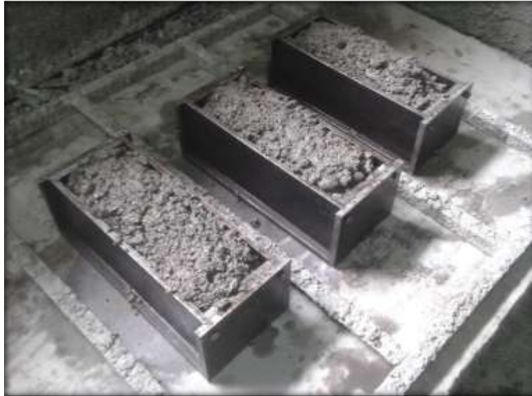
Figura III-5: Moldes llenos de hormigón antes del vibrado.
