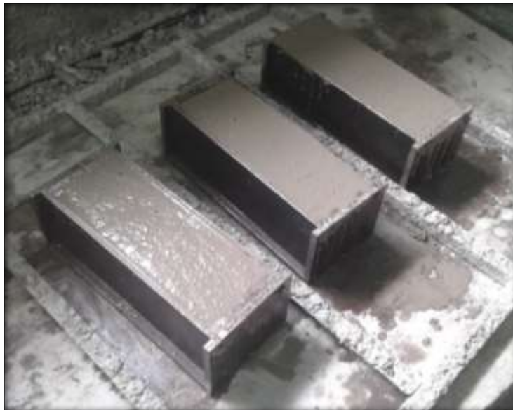
Figura III-6: Moldes platachados posterior al vibrado.
