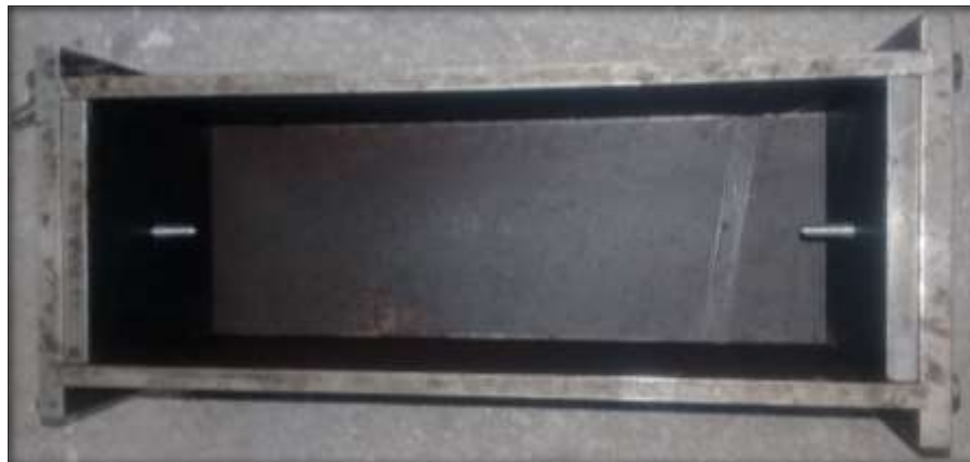
Figura III-4: Vista superior del molde de la viga de hormigón.
