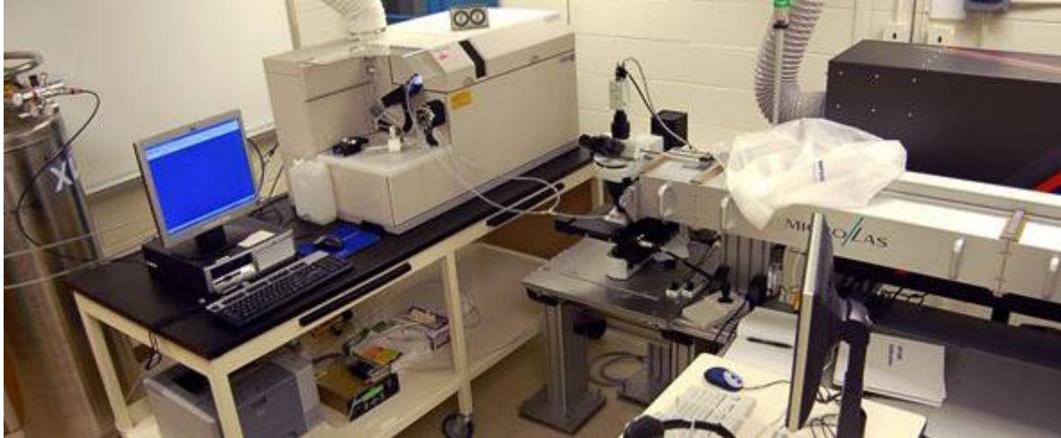
Figura 20: LA-ICPMS Agilent 7500ce ICPMS quadrupole mass spectrometer acoplado a un sistema de ablación GeolasPro Eximer 193-nm ArF laser ablation system. Perteneciente a Virginia Tech.
