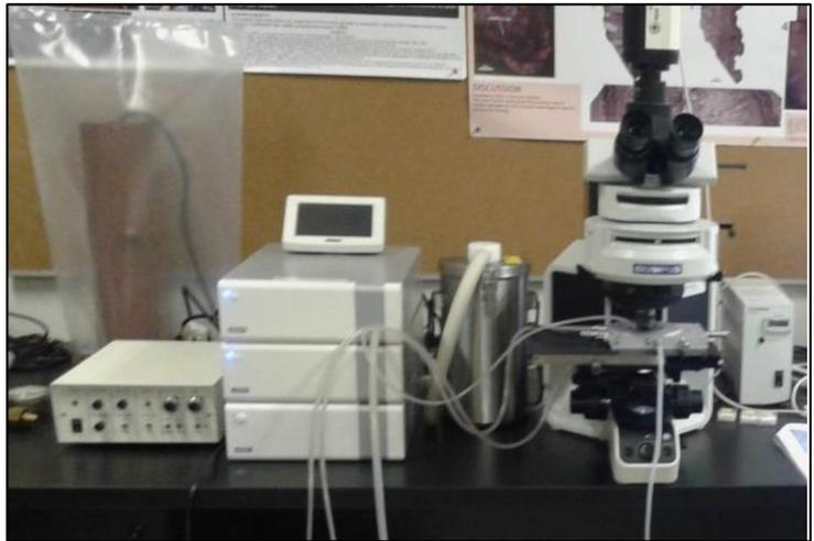
*Figura 12: Microscopio Olympus BX53 utilizado conectado con LINKAM THN-600.*
