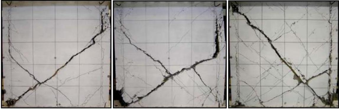
*Figura 9-2: Modo de Falla en muros de HRF [23].*
