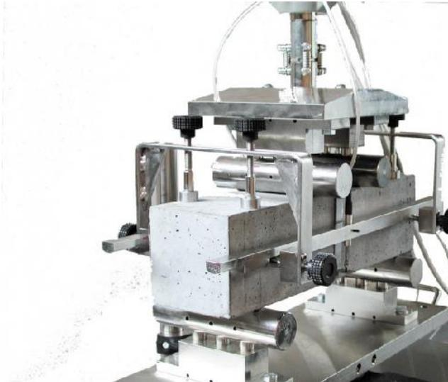
Figura 2-12: Configuración ensayo ASTM C1018 [15].
