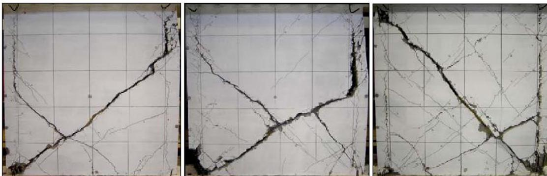
Figura 4-6: Falla de los muros tipo 2F (d), (e) y (f) [23].
