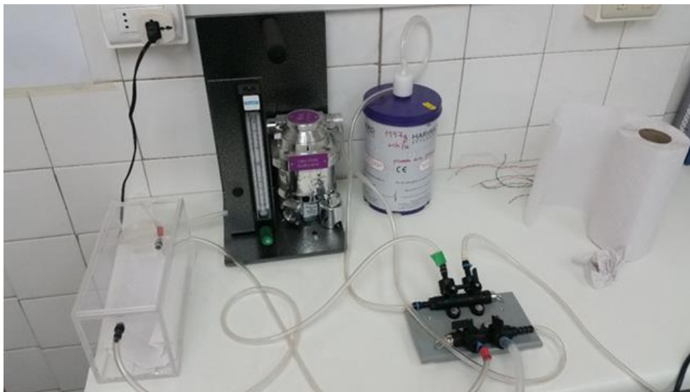
Figura 9. Montaje de equipo de Anestesia. Vaporizador de Sevoflurano, caja de inducción y circuito para mantención de sedación.
