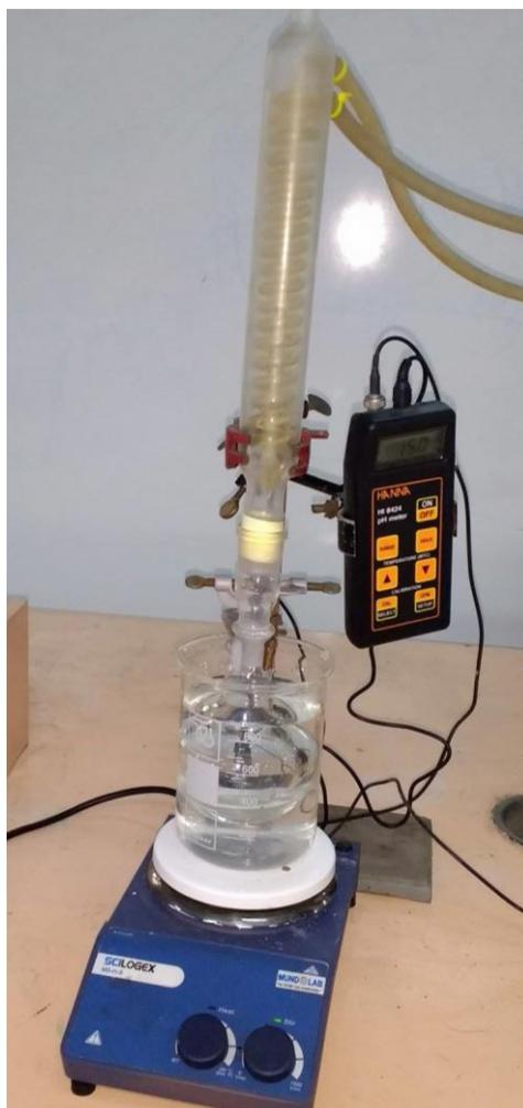
Figura 26: “Montaje para la transesterificación”
