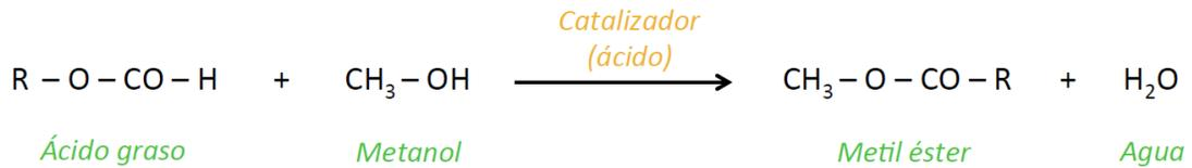
Figura 18: “Reacción de Esterificación” [28]
