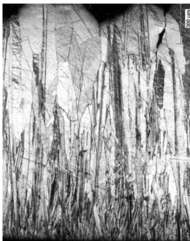
FIGURA 29: MICROGRAFÍA ÓPTICA DE CÁTODO DE COBRE OBTENIDO A 300 A m -2 EN UN ELECTROLITO DE 40 mg l -1 DE Cl - . [47]
