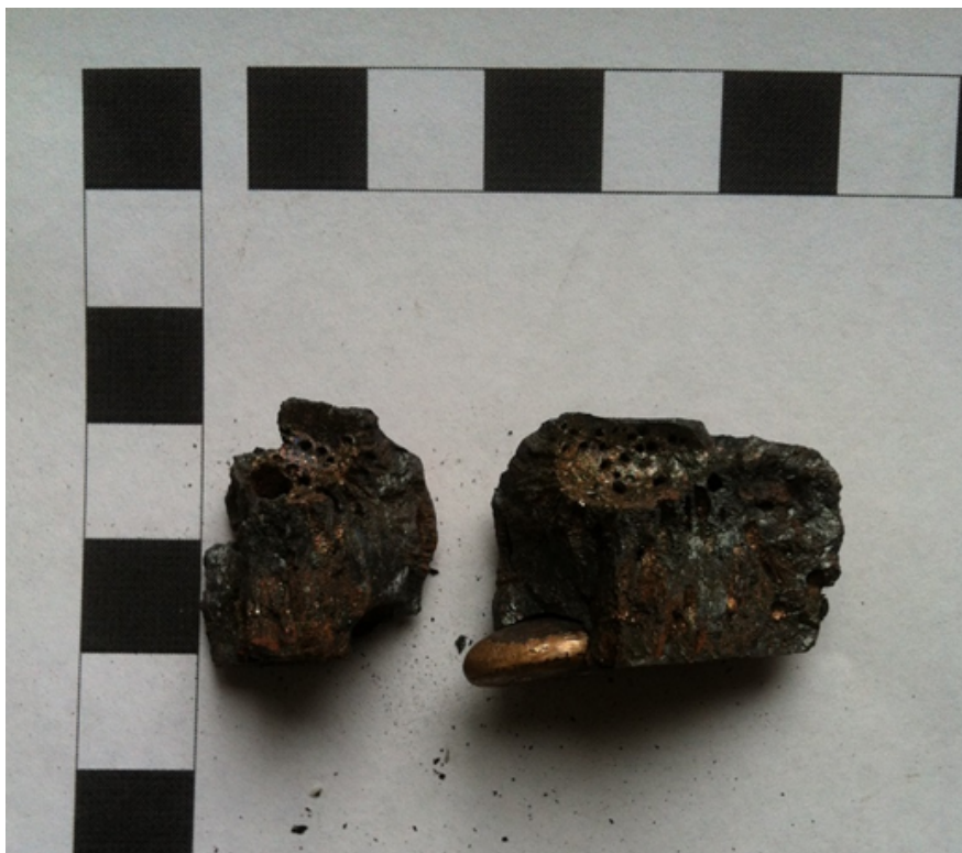
Figura 4.17: Muestra de metal blanco (pedazos) con botón formado(inserto), pertenecientes a la prueba 2.
