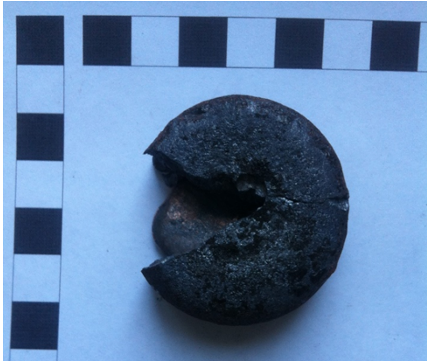
Figura 4.24: Muestra de metal blanco con botón metálico (inserto), formados en la prueba 3.
