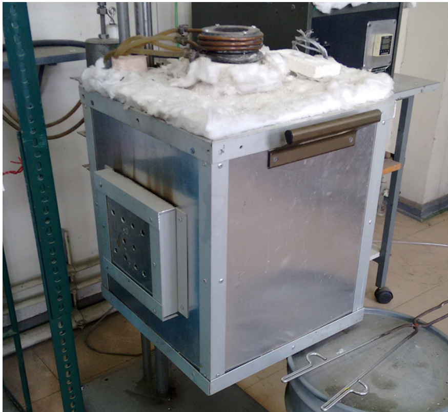
Figura 3.2: Horno de laboratorio a utilizar en las pruebas de equilibrio.
