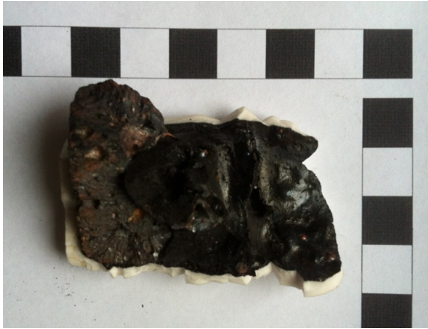
Figura 4.12: Muestra de fases de escoria (derecha) y metal blanco (izquierda) de la prueba 1.
