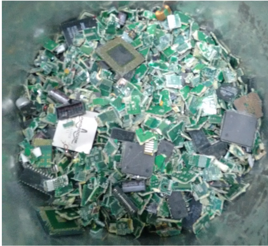
Figura 4.1: Placas de circuito impreso de la muestra una vez reducidas de tamaño.
