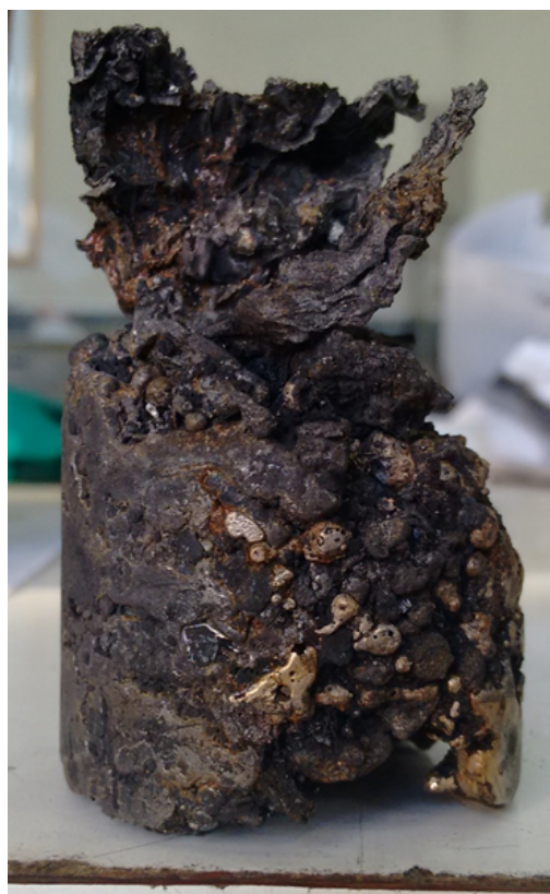
Figura 4.3: Botón metálico formado después de la segunda fusión.
