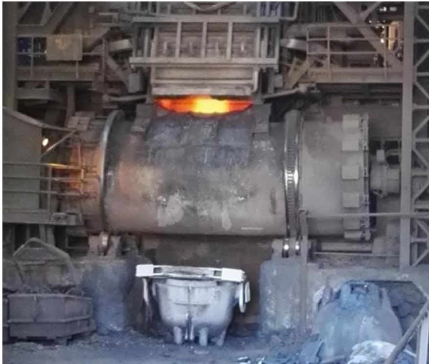
Figura 2.7: Convertidor Peirce-Smith de Fundición Chagres en operación.
