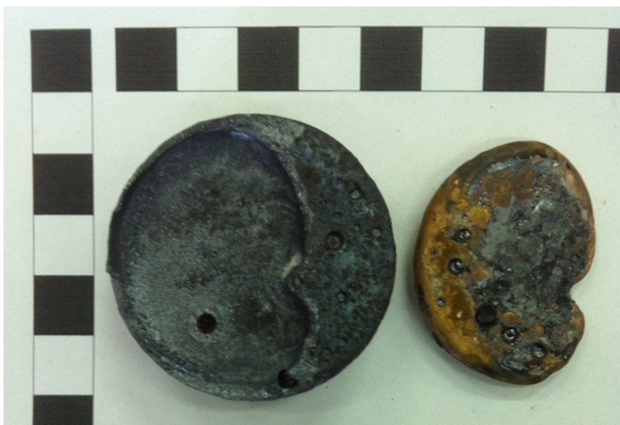
Figura 4.32: Fase de metal blanco (izquierda) junto a botón metálico (derecha) formados en la prueba 4.
