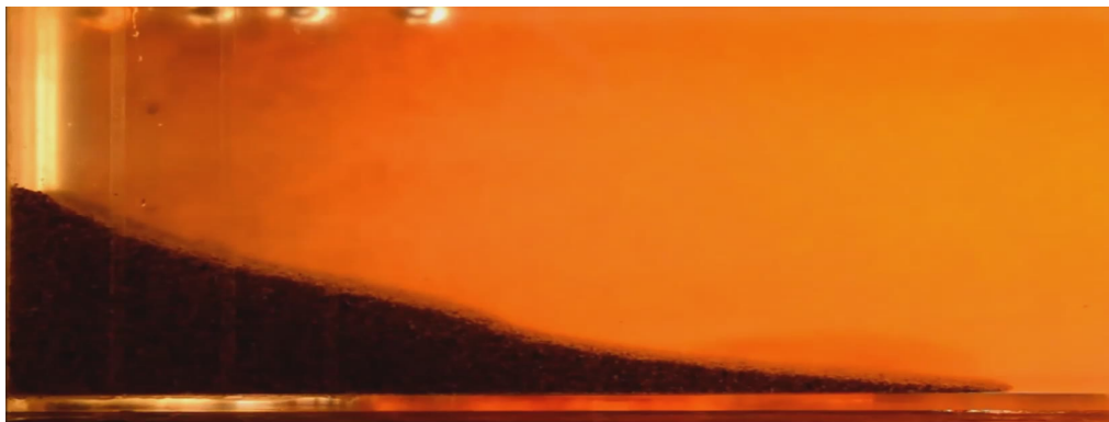
Figura 5.33: Condición final colapso de columna de arena en CMC2.
