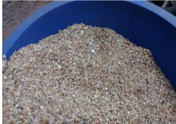
b) Arena de diámetro medio 1.2 \text{ mm}
