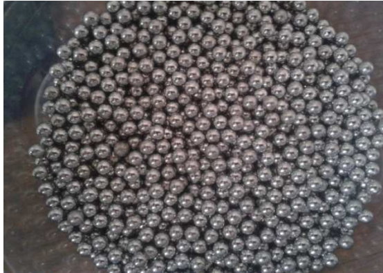
Figura 3.2 a) Esferas de acero, diámetro 4.5 \text{ mm}
