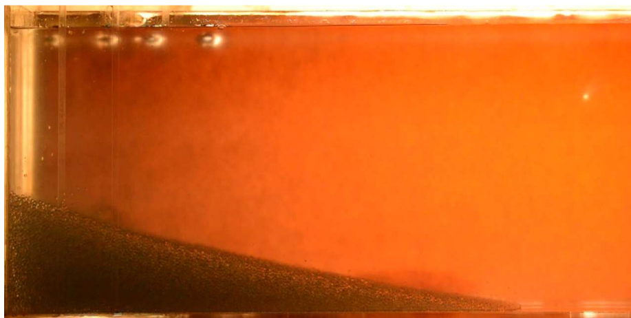
Figura 5.34: Condición final colapso de columna de esferas de vidrio en CMC2.
