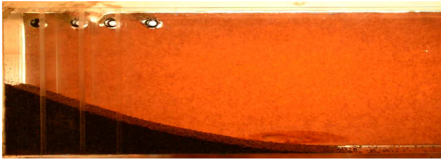
Figura 5.23: Condición final colapso de arena en aire.
