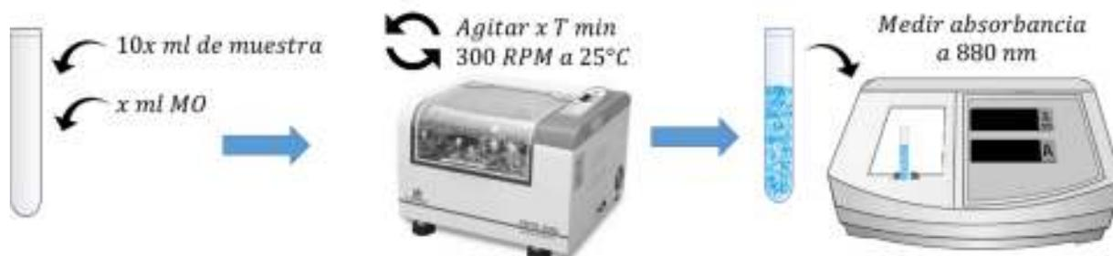
Figura 16. Esquema del procedimiento de la medición de As(V).
