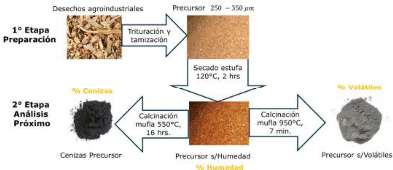
Figura 10. Esquema proceso de preparación y análisis próximo del precursor.
