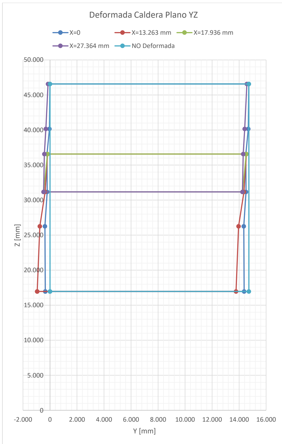
Gráfico 46: Deformada Caldera Modelo ISE - Plano YZ.
