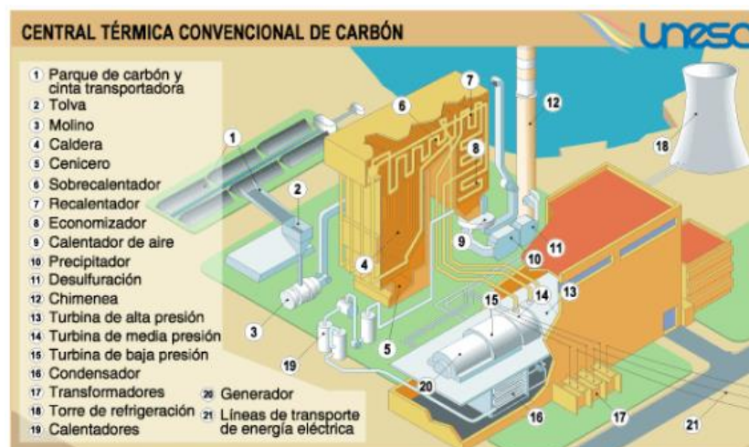
Figura 3: Central Térmica Convencional.
