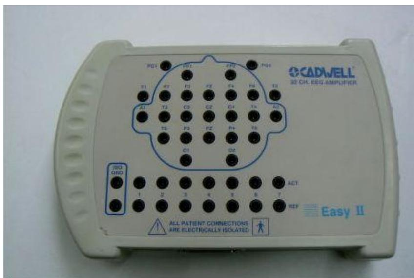
**Figura 24:** Electrógrafo Easy-II de la marca Cadwell. Se observa topológicamente la ubicación de los electrodos para su posterior posicionamiento sobre el cuero cabelludo del paciente. La imagen es obtenida de [www.dotmed.com](http://www.dotmed.com).
