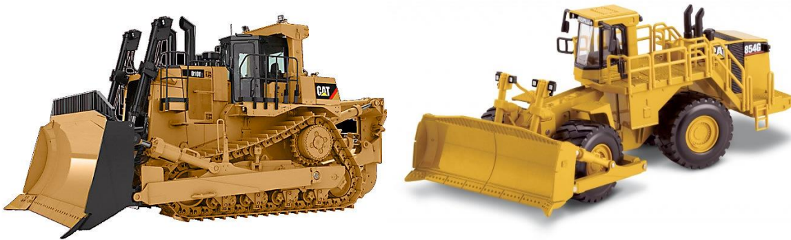
Ilustración 7: A la izquierda Bulldozer, a la derecha Wheeldozer
