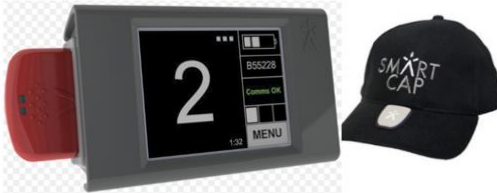
Ilustración 6: Sistema de monitoreo por lectura de ondas cerebrales.
