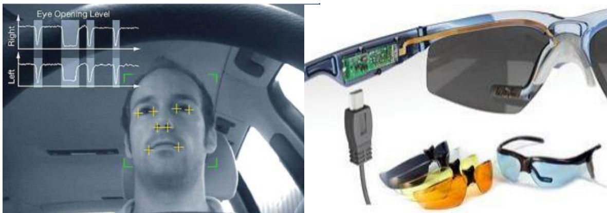
Ilustración 4: Sistemas de detección de velocidad de parpadeo y porcentaje de cierre de párpado
