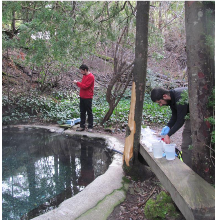
Figura 2-5: Piscina en la cual se tomó la muestra del área termal Panqui. La toma de muestra se realizó lo más próxima posible a la tubería que recarga la piscina.
