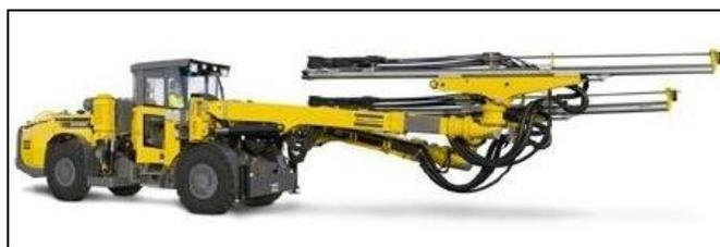
Ilustración 9. Jumbo Atlas Copco 282 FOPS/ROPS.
