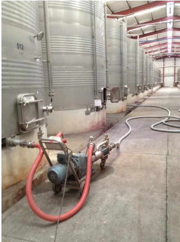
FIGURA 17: Foto de una instalación para realizar un trasiego de mosto o vino.
