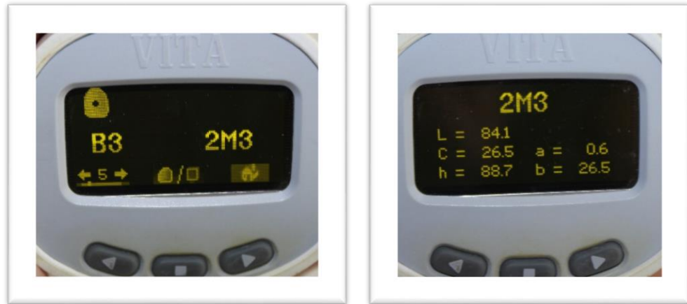
Figura 11: Izquierda: Determinación de color dental con espectrofotómetro Easy Shade® Compact, en los sistemas cromáticos VITA classical A1-D4 y VITA SYSTEM 3D. Derecha: Descomposición del valor según las coordenadas del sistema CielAB.
