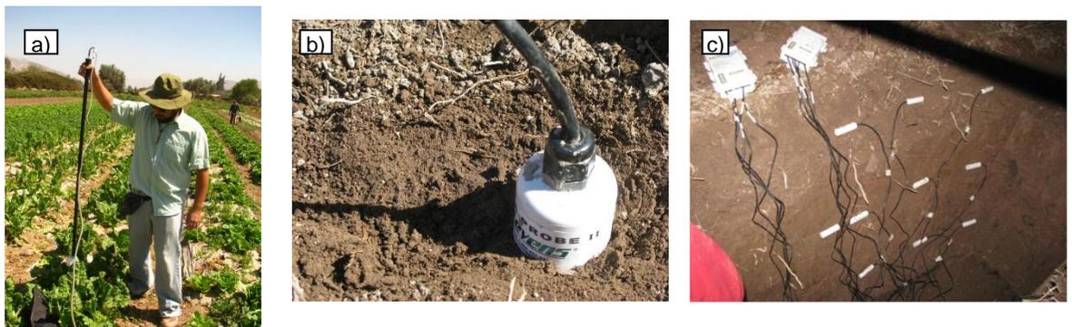
**Figura 1.** Sensores utilizados para la estimación del contenido de agua. (a) Sensor FDR, Diviner 2000; (b) Sensor FDR, POGO; (c) Sensor TDR, GS3.
