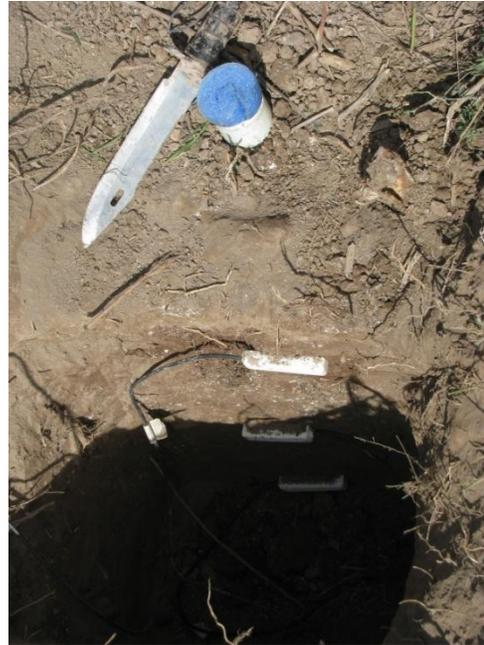
**Figura 3.** Parcela de calibración sensor Diviner 2000. (Izquierda) Esquema de la parcela de calibración del sensor en profundidad. (Derecha) Parcela de calibración montada en fundo La Castellana.
