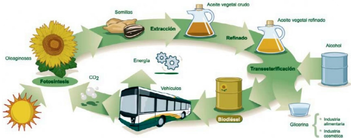
Figura 2. Diagrama de la obtención de biodiésel a partir de aceite vegetal (Lumbreras, 2005)
