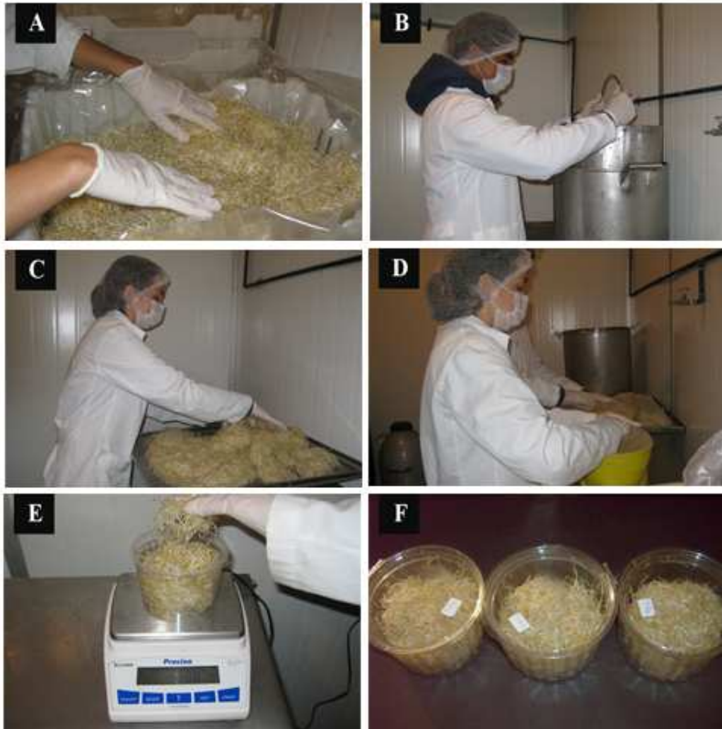
Figura 2. Procesamiento de germinados de alfalfa. (A) Recepción de materia prima; (B) Lavado; (C) Escurrimento; (D) Centrifugado; (E) Pesaje; (F) Envasado.
