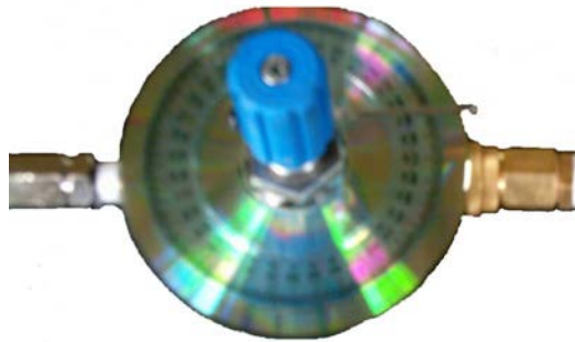
Figura 8. Regulador de caudal dividido en diferentes posiciones, grados sexagesimales.
