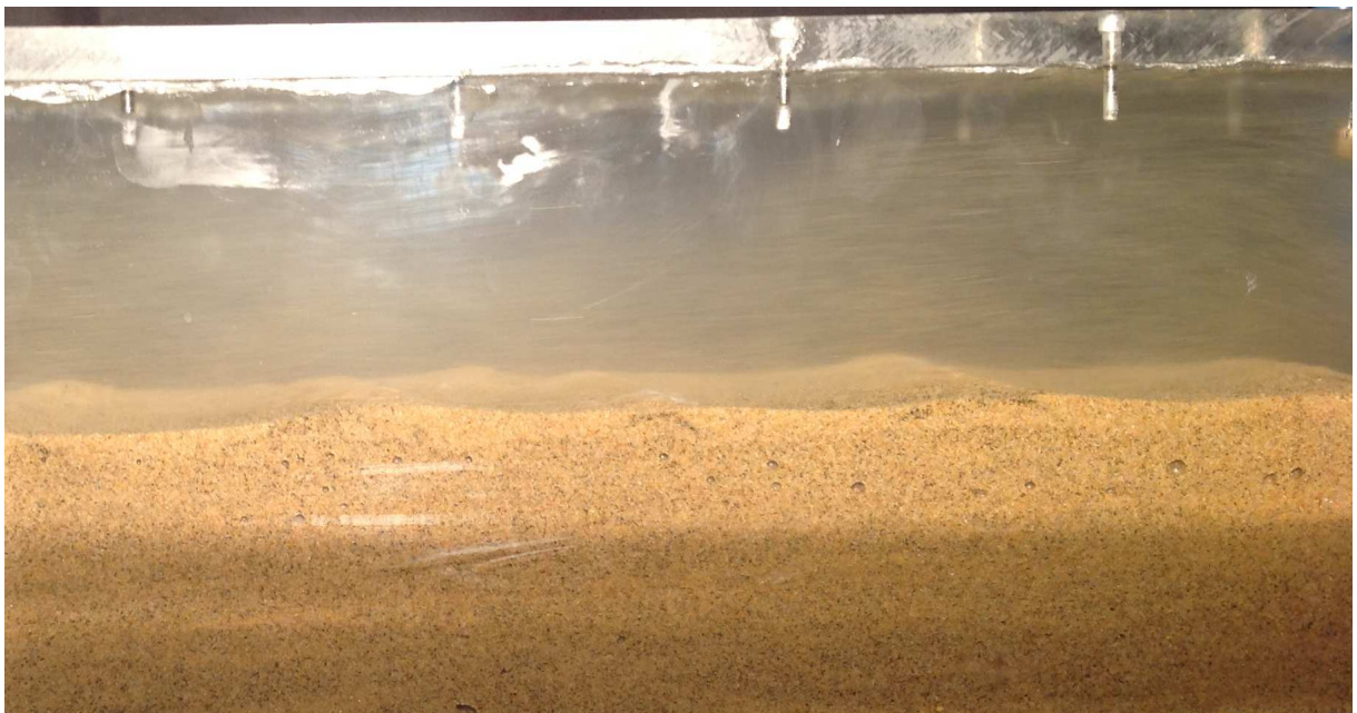
Figura 4.9: Fotografía lateral de las formas de fondo que se generaron durante la prueba 4.
