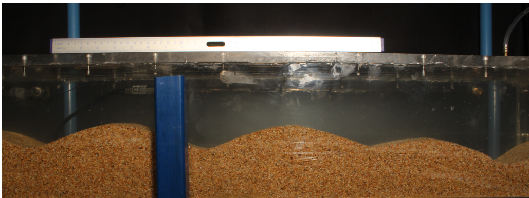
Figura 4.13: Fotografía lateral de las formas de fondo que se generaron durante la prueba 5 con escala de 50 cm en la parte superior.
