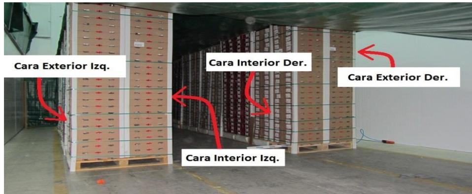
Figura 3. Esquema de un sistema de aire forzado. En esta figura se indican las caras exteriores e interiores de los pallets dentro del túnel de aire forzado. Fuente: Luchsinger, 2013.
