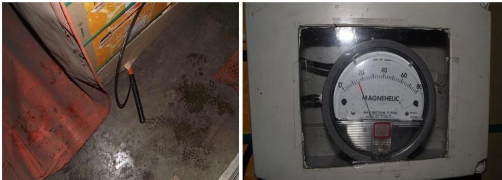
Figura 7. La imagen de la izquierda muestra la manguera utilizada para medir la presión de succión en el plenum del pallet (zona de medición de presión de succión) en la imagen de la derecha se muestra el vacuómetro utilizado dentro del túnel de aire forzado el cual registra la presión de succión en milímetros de columna de agua.
