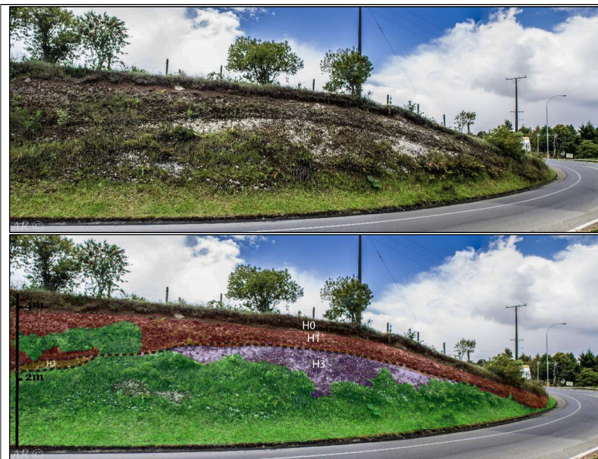
Figura 73 Sitio 3 de la Figura 70 . Se distinguen 3 unidades principalmente. Tanto la unidad H1 como la unidad H3 son depósitos consolidados color pardo oscuro-gris, mal seleccionados, matriz soportados con una baja madurez textural correspondientes a las morrenas de la glaciación Llanquihue y Santa María respectivamente. Por otro lado, la unidad H2 corresponde a material piroclástico semi-consolidado de tamaño ceniza a lapilli y color anaranjado, posiblemente originados en alguna erupción del volcán Calbuco. H0 corresponde a un suelo actual.
