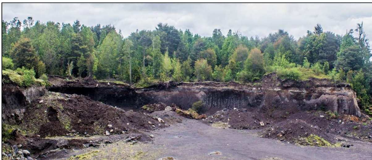
Figura 32 Actual cantera en el sector de Colonia Río Sur, en donde se extraen áridos de la unidad geológica Ignimbrita Alerce y depósitos volcanoclástico Hap3. Referencia: Selles y Moreno (2011)
