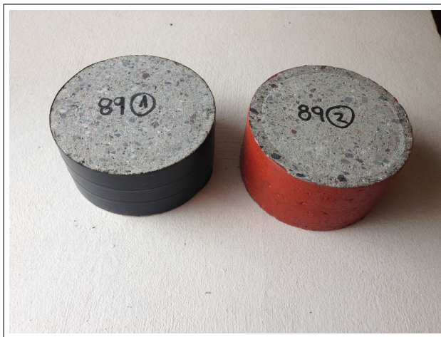
(a) Sellantes. Izquierda: huincha aislante sobre silicona, derecha: silicona roja
