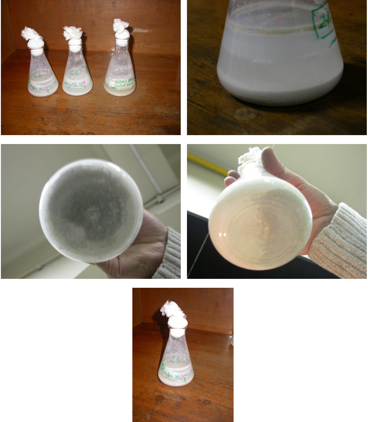
Figura 4.17. Fotografías matraces del Cultivo de A. thiooxidans en medio de cultivo con cemento endurecido.
