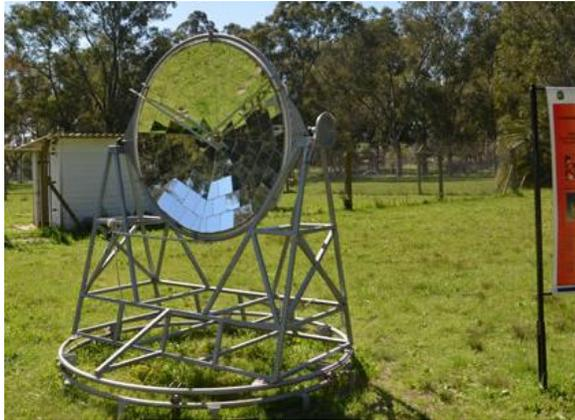
Figura 6: Disco Stirling para uso distribuido [13].
