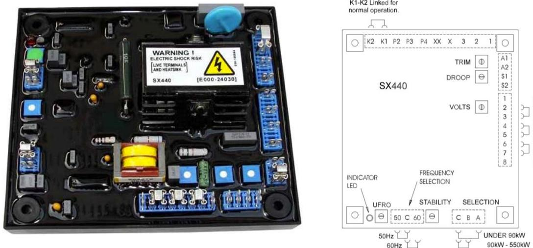
Figura 24: AVR SX440: real (izquierda) y esquemático (derecha).
