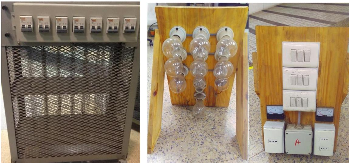
Figura 29: Cargas resistivas. A la izquierda un reóstato con interruptores y a la derecha un arreglo de ampolletas.
