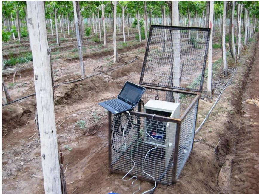
**Figura 1. Unidad Hydra Probe instalada en campo**
