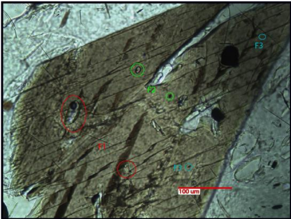
Figura 63. Cristal aE visto en nícoles paralelos en aumento de 20x. Se observan las maclas pequeñas alargadas y algunas de las inclusiones vítreas más grandes.
