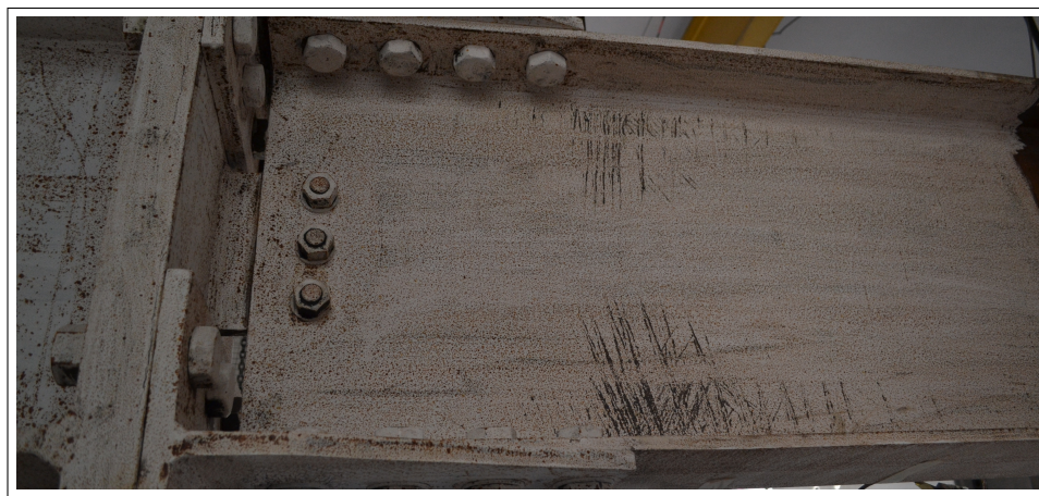
Figura 5.6: Comparación de deformaciones plásticas al final del ensayo en rótula SE-01.
