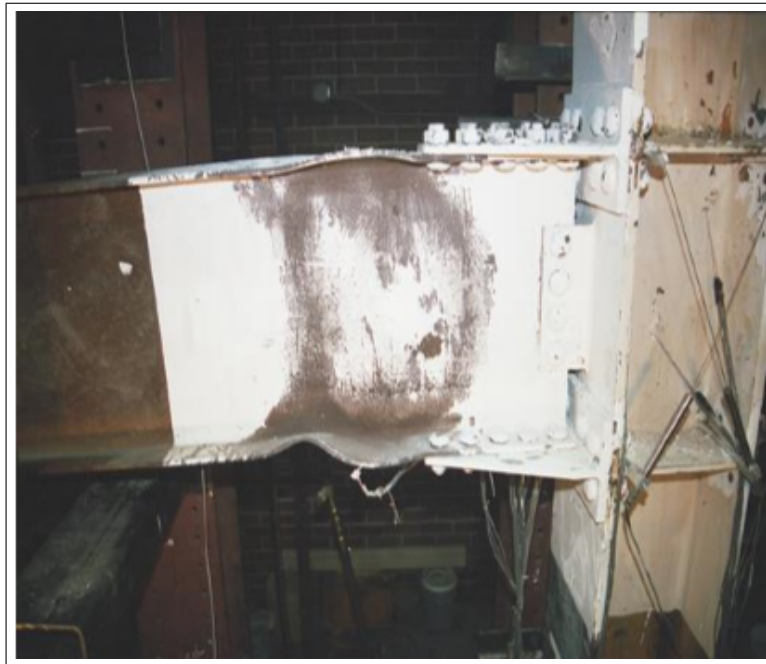
Figura 2.9: Formación de rótula plástica y pandeo local del ala de espécimen FS-08. Fuente: Smallidge (1999)
