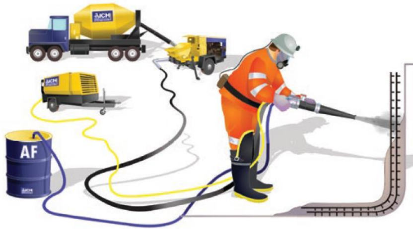
Figura 1: Hormigón Proyectado por vía húmeda (Guía Chilena del Hormigón Proyectado, 2015).
