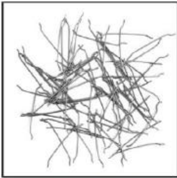
Macrofibras de acero anclada suelta.
