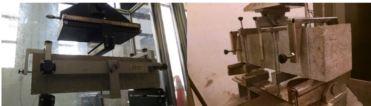
Figura 12: Ensayo de Resistencia residual con las prensas de resistencia residual, marca ToniTechnik (a la izquierda) y Controls (a la derecha).
