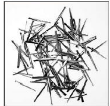
Macrofibras metálicas fresadas.
