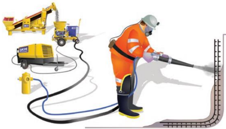
Figura 2: Hormigón Proyectado por vía seca (Guía Chilena del Hormigón Proyectado, 2015).
