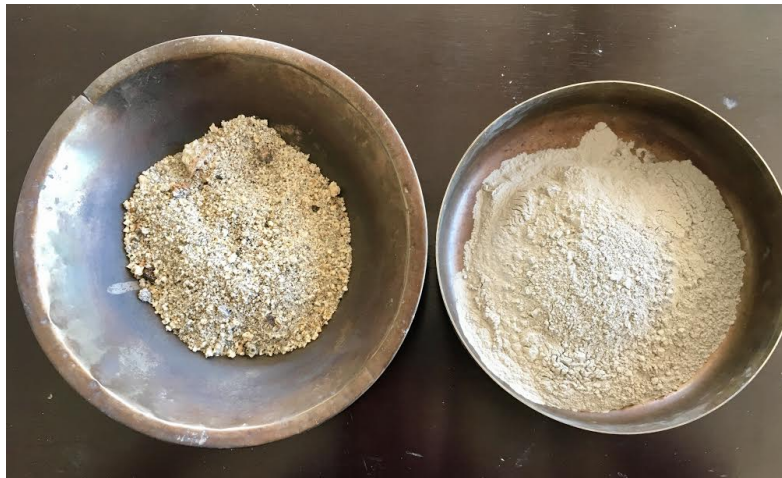
Figura 9: Escoria de alto horno. A la izquierda, escoria sin procesar y a la derecha, escoria luego de ser molida.
