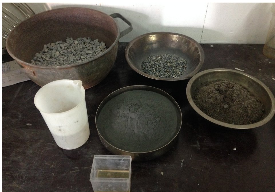
Figura 12: Materiales para fabricar hormigón geopolimérico.
