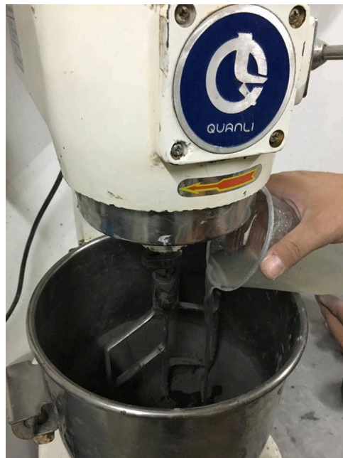
Figura 14: Adición de componentes líquidos a la mezcla seca.
