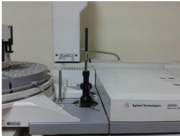
Figura 4. Disposición de la fibra en GC-MS para la desorción térmica de la muestra.
