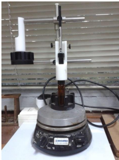
Figura 3. Disposición de la muestra para el proceso de extracción mediante SMPE.
