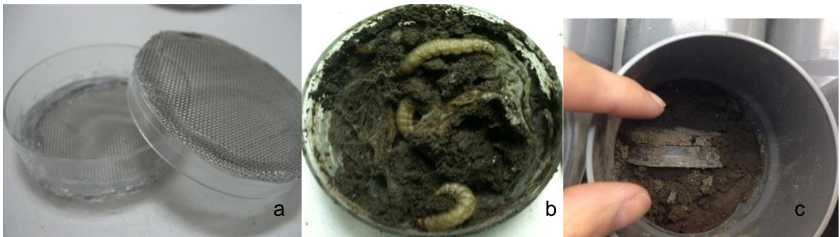
Figura 4. (a) Placas Petri plásticas con malla de acero inoxidable en ambas caras, (b) se llenan con suelo y se colocan cinco larvas de G. mellonella de último estadio, y (c) la placa se introduce dentro del tubo de PVC con suelo del mismo tipo.
