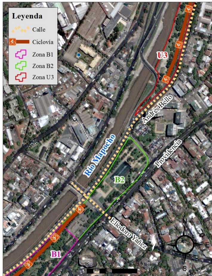
Figura 26. Desconexión de la ciclovía entre zonas B1-B2-U3.
