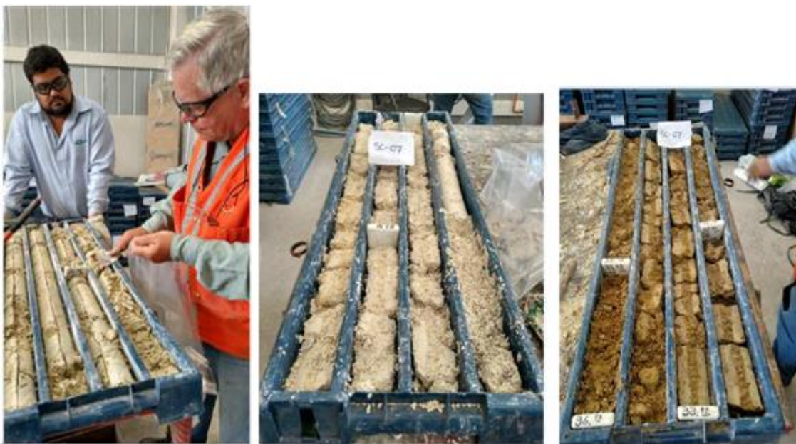
FIGURA 4.3 DESCRIPCIÓN Y COMPOSITACIÓN DE MUESTRAS CON CORTE DIAMETRAL
