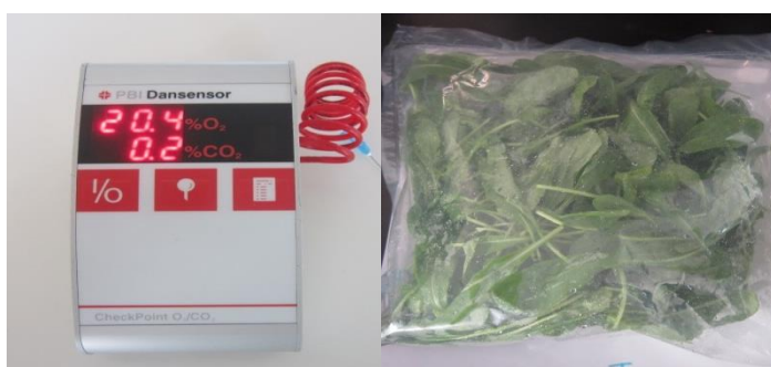
Figura 2.6. Medición de la atmósfera modificada pasiva.
